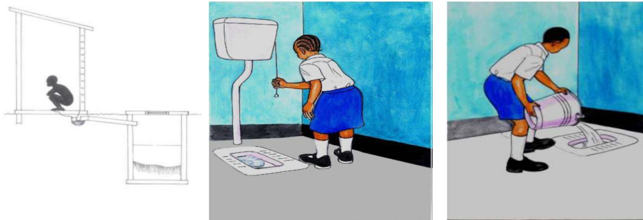
Type de latrines à chasse eau
